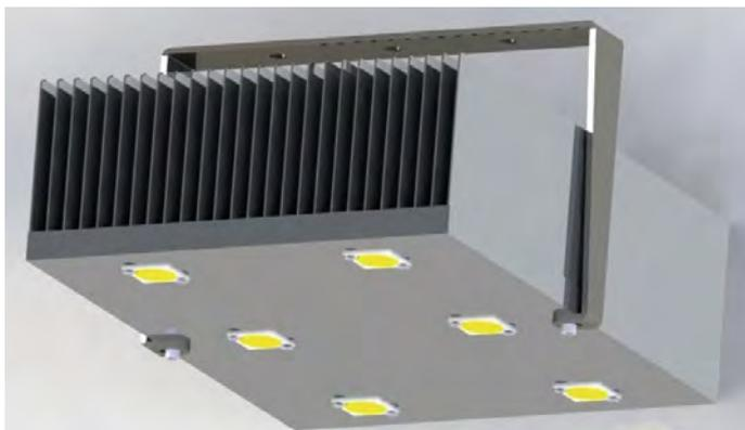
Рис. 3. Трёхмерная модель светильника с пластинчатым ребристым радиатором
