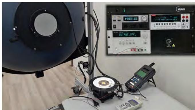
Рис. 2. Терморегулируемая интегрирующая сфера и измерительное оборудование
