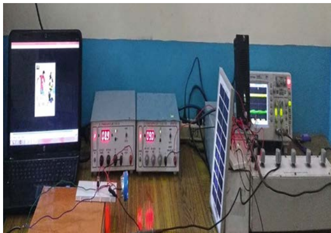
Рис. 21. Модифицированная для передачи аудиосигналов блок-схема предлагаемой системы VLC, в которой в качестве приёмника используется с солнечная панель
