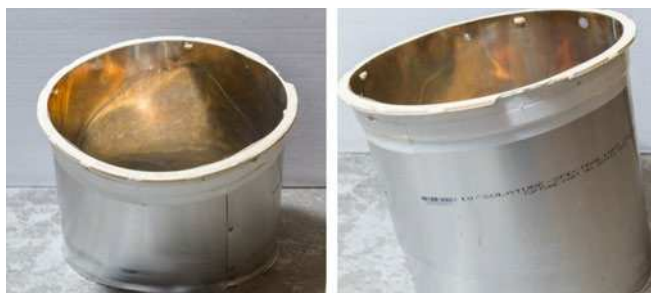
Рис. 6. Вид зеркального тубуса световода на основе полимерной плёнки «DF2000MA» после определённого срока эксплуатации без УФ поглощающего фильтра
