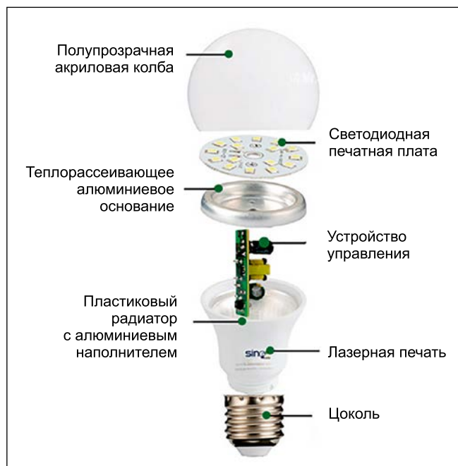
Рис. 6. Основные компоненты светодиодной лампы прямой замены
