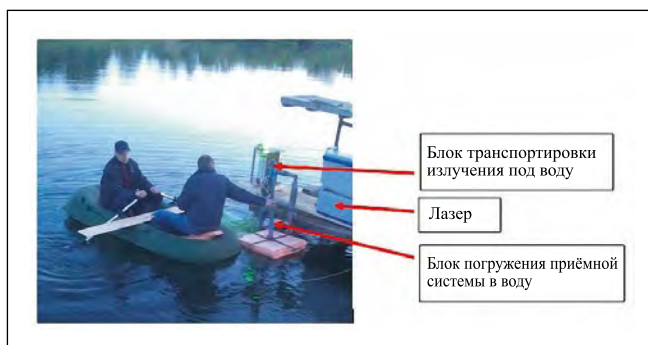
Рис. 2. Фотография участников экспериментов, перемещающих приёмный блок по озеру, и основных блоков лабораторного макета ОЭСС
