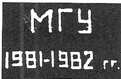
Рис. 12. Надпись, сделанная электронным пучком на плёнке p - GaN:Zn
