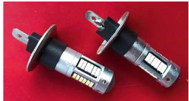
Рис. 1. Внешний вид исследованных СД ламп Gtinthebox с типом цоколя H1
