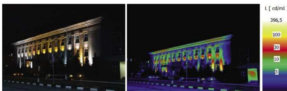
Рис. 7. Фотография освещённого фасада (слева) и представленное в псевдоцветах распределение яркости по фасаду (справа), Староникитская ул., дом 1
