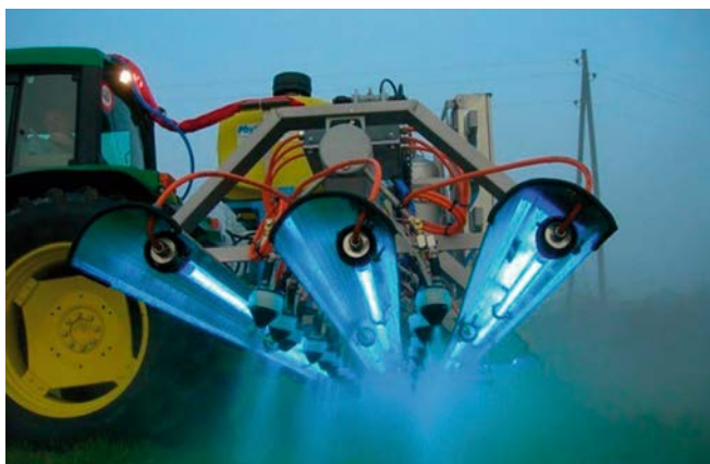
Рис. 7. Платформа с УФ лампами, навешиваемая на тракторы
