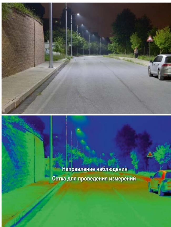
Рис. 4. Полученное яркомером изображение экспериментального участка дороги
