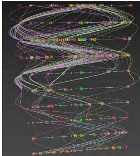
Рис. 2. Диаграмма многомерных данных, связывающая условия и методы формования объёмных ММК Al/SiC с основными свойствами материалов (КТ и КТЛР)
