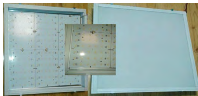
Рис. 3. Встраиваемый в потолок светильник с шестью СД панелями, закрытыми рассеивателем из плексигласа для обеспечения равномерного распределения яркости
