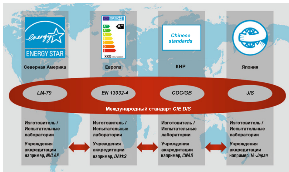
Рис. 1. Упрощённая ситуация в области международной стандартизации светотехнических измерений. Новый международный стандарт окажет существенное влияние на желательные гармонизацию и сопоставимость разных метрологических и аккредитующих учреждений (обозначены красными стрелками)
