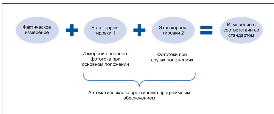
Рис. 3. Схема корректировки положения программным обеспечением
