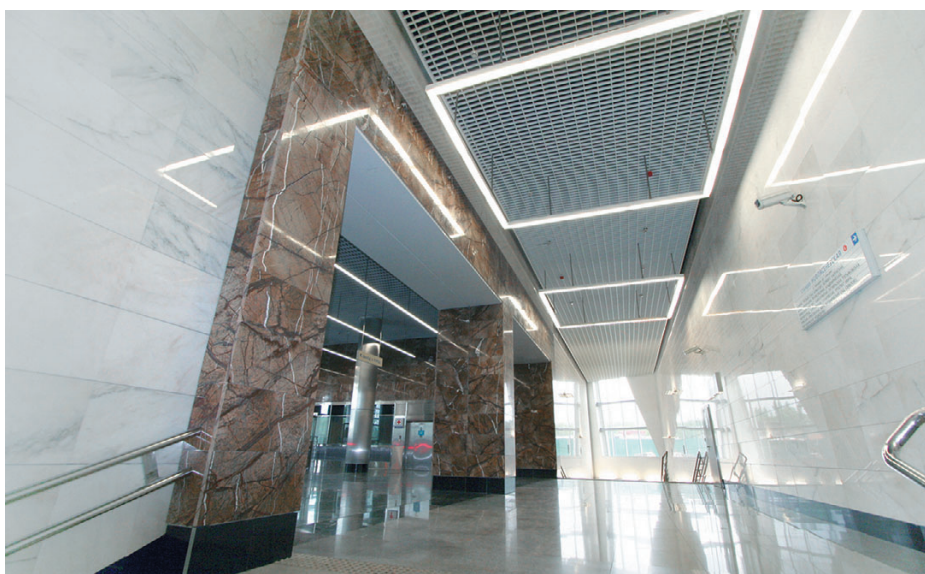
Рис. 12. «Битцевский парк». Наземный вестибюль. Подвесные рамные светильники
