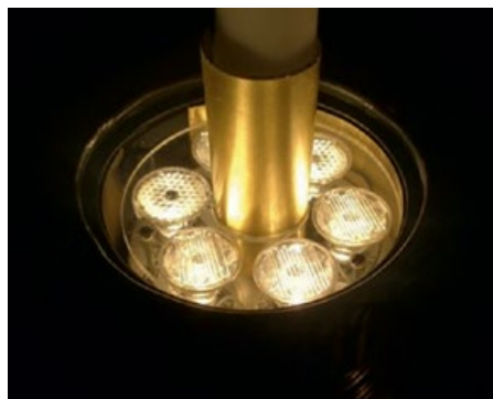
Рис. 7. Варианты рассеивающих структур конвертеров
