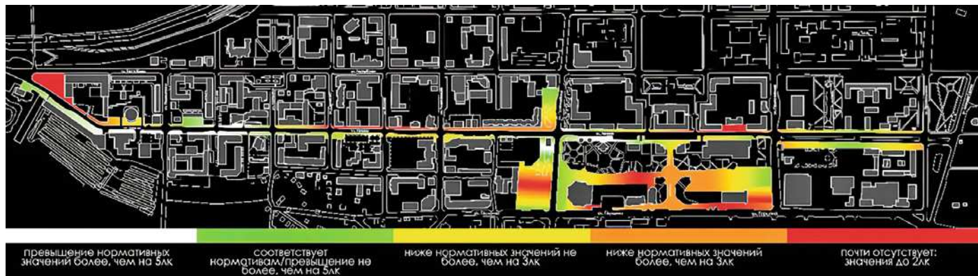
Рис. 1. Схема соответствия уровня освещённости пешеходных зон улицы Ленина нормативам СП 52.13330.2016, на основании отчёта по инструментальному обследованию приоритетных объектов городской среды (август 2017 г.)
