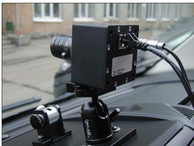
Рис. 1. Цифровой яркомер, установленный в кабине автомобиля
