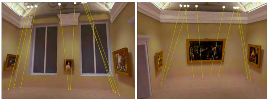
Рис. 10. Расположение и нацеливание трековых светильников для освещения картин
