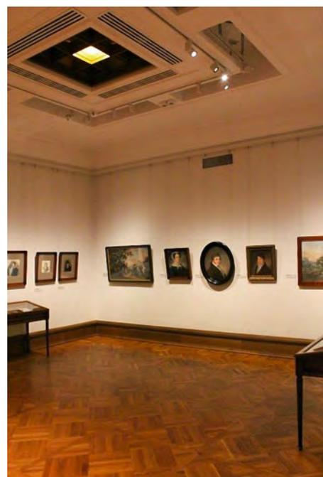
Рис. 3. Зал графики. Освещённость экспонатов на высоте 1,6 м за счёт акцентирующего освещения составляет 60 лк
