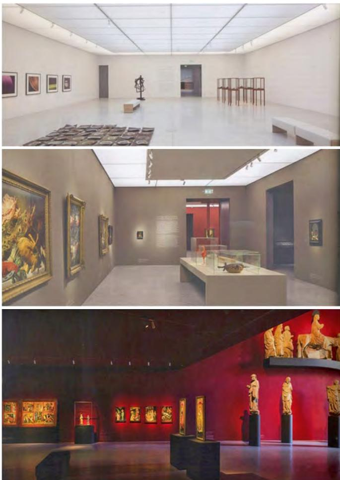
Рис. 7. Залы с разной яркостной адаптацией, обусловленной сочетаниями разноинтенсивных и разнотипных систем искусственного освещения и разной отделкой внутренних поверхностей
