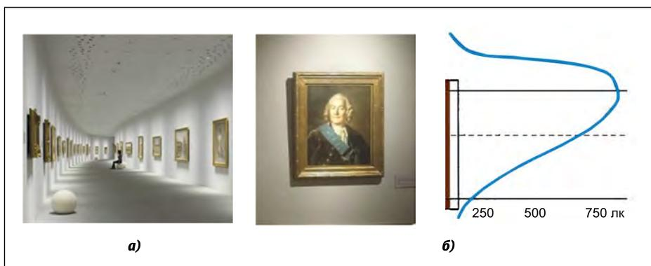
Рис. 3. Освещение произведений живописи традиционными подвесными ОП: а – внешний вид галереи, б – распределение освещённости на картине по вертикали
