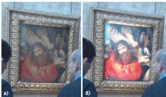
В результате удалось избавиться от искажений следа светового пучка на освещаемом объекте, характерного для простых объективов, и увеличить ИЦП с 95 до 98.
