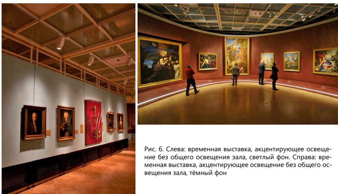
Рис. 6. Слева: временная выставка, акцентирующее освещение без общего освещения зала, светлый фон. Справа: временная выставка, акцентирующее освещение без общего освещения зала, тёмный фон
