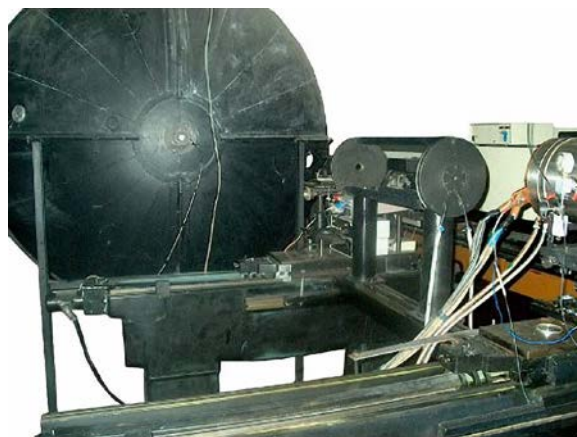
Рис. 1. Государственный первичный эталон единицы силы света и светового потока, ВНИИОФИ, Москва
