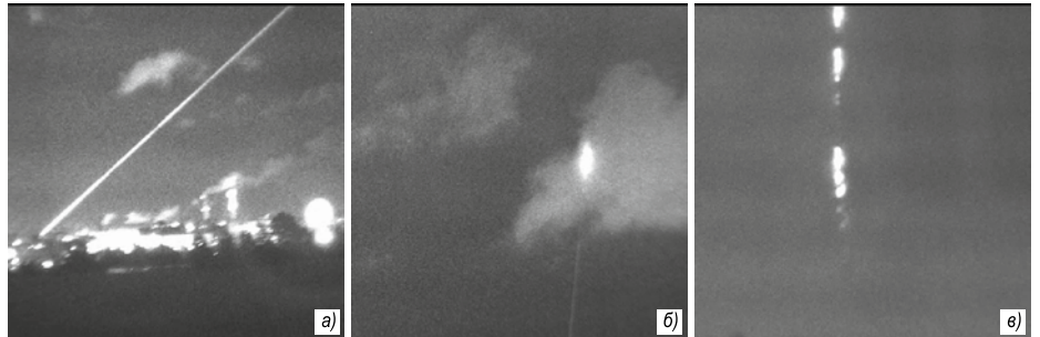
Рис. 3. Кадры из видеозаписей: (а) – информационного лазерного луча, рассеянного на безоблачной трассе в атмосфере, (б) – рассеянного излучения, прошедшего облачное образование, и (в) – излучения, рассеянного на аэрозольных неоднородностях
