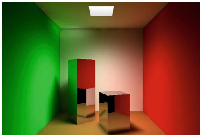
Рис. 1. Пример визуализации пространственно-углового распределения яркости локальными оценками метода Монте-Карло для эталонной сцены Cornell Boxes
