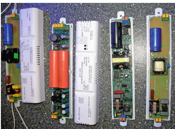
Рис. 21. Управляющие устройства и блок аварийного питания на базе микропроцессора. «НПП «Электроника»
