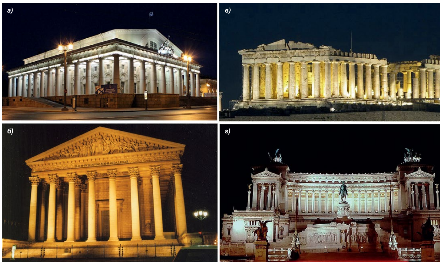
Рис. 2. Световая архитектура ордерной архитектуры: негативный (а – Биржа в Петербурге) и позитивный (б – ц. Св. Магдалены в Париже) контрасты колоннады и фоновой стены. Антаблемент периптера Биржи визуально разрушен лентой света на фризе и карнизе; освещение фасадов (в – Парфенон в Афинах, г – Дворец Виктора Эммануила в Риме). Яркостный контраст колоннады и стены не обеспечивает выразительный пространственно-тектонический эффект
