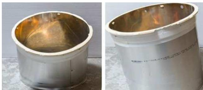
• Зеркальный материал «*MiroSilver*» получается путём осаждения испарённого серебра на алюминиевую подложку и закрепления его оксидами  $\text{SiO}_2$  и  $\text{TiO}_2$ . При этом никакого клея уже не используется.
