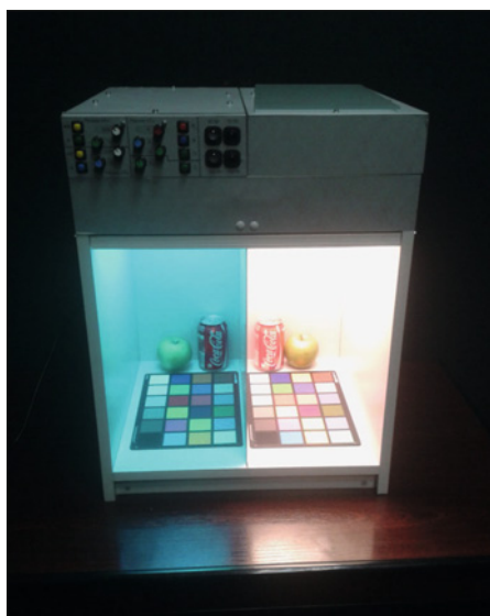
Рис. 2. Внешний вид камеры визуальной оценки цветопередачи, подготовленной к эксперименту. Правая половина камеры освещена опорным источником, а левая светодиодным источником света «3»
