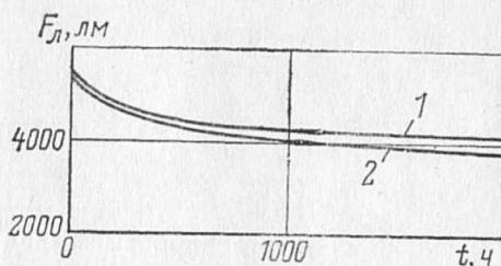
Рис. 1. Спад светового потока люминесцентных ламп.
