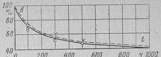
Изменение яркости ЭЛП в процессе эксплуатации (500 Гц, 220 В).
