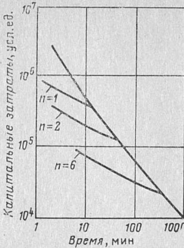
Рис. 2. Зависимость капитальных затрат на создание ГПС от числа рабочих позиций  $n$  и времени их загрузки
