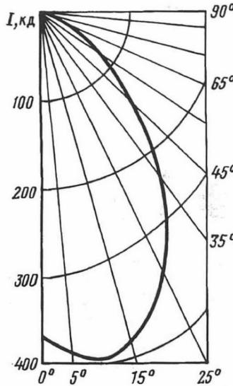
■ Рис. 1. Кривая силы света зеркальной ГЛН типа КГЭИ 12-50
