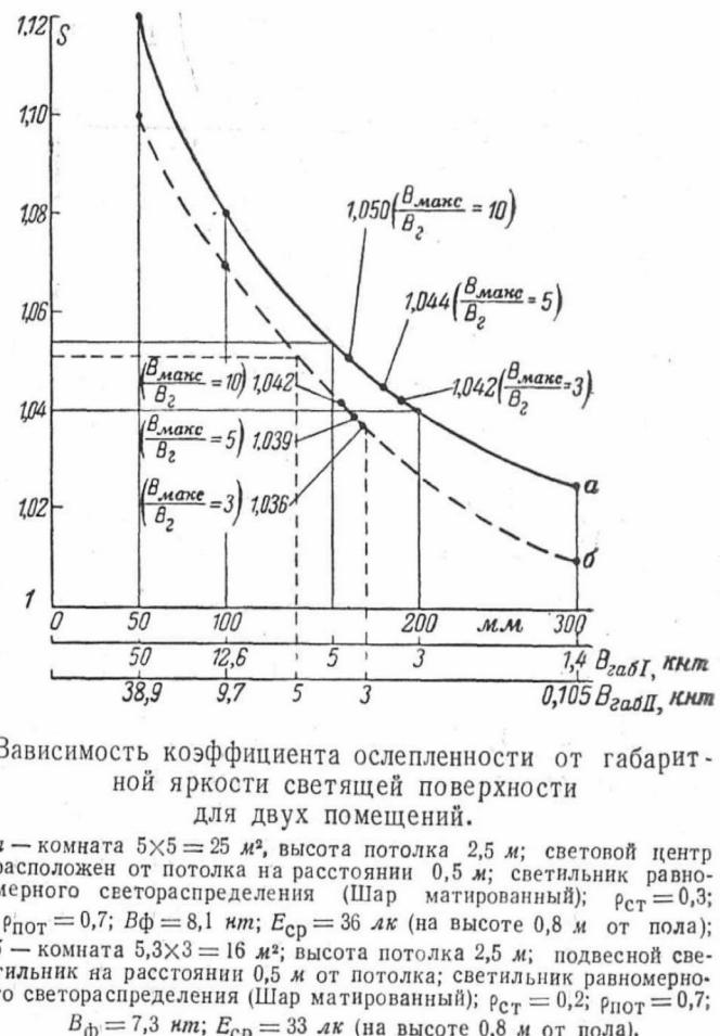
Зависимость коэффициента ослепленности от габаритной яркости светящей поверхности для двух помещений.
