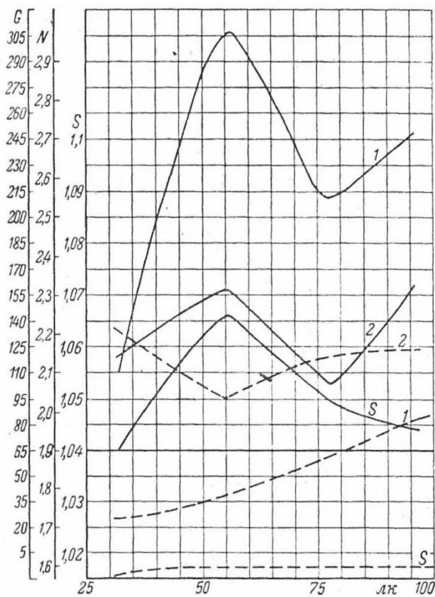
Рис. 3. Сопоставление методов расчета ослепленности от шаров молочного стекла,  $\rho_{р.п} = 0,4$ .
