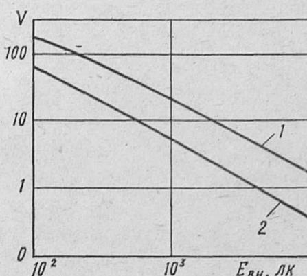
Рис. 4. Рассчитанная видимость ЗСИП типов ЗЛС338Б (1) и ИВ-22 (2) в зависимости от внешней освещенности при угловом размере высоты знаков  $30'$
