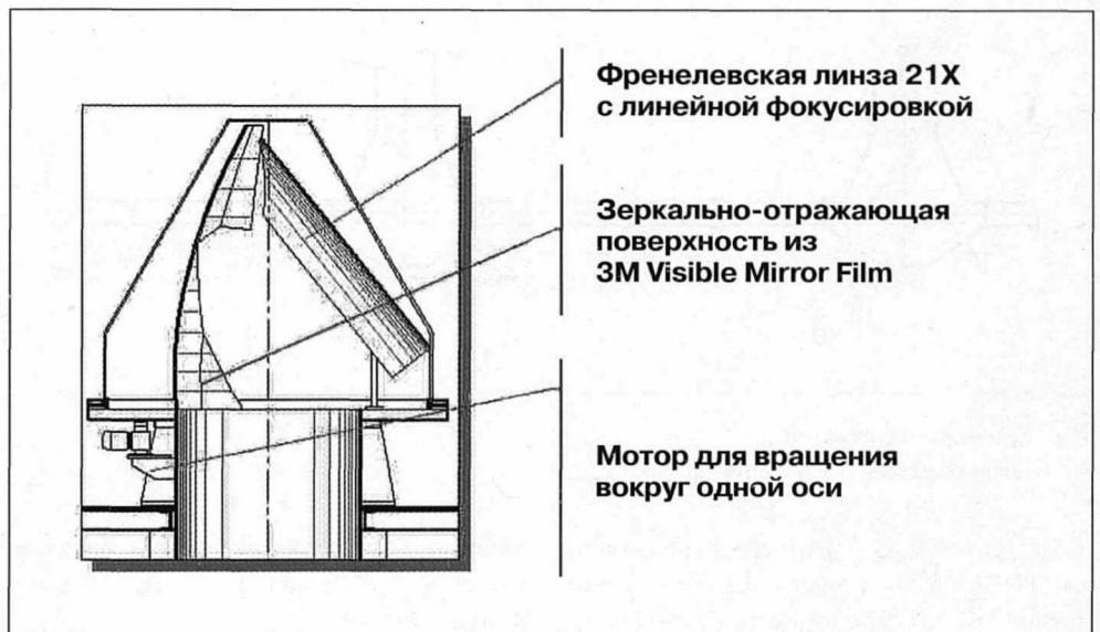
Рис. 6. Функциональная схема концентратора
